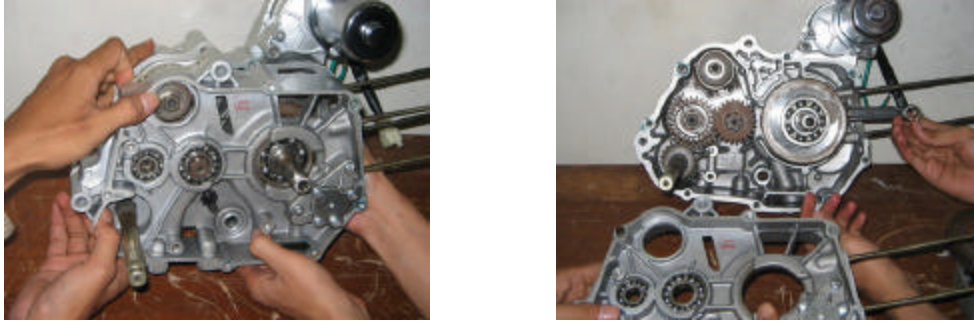
Gambar 4a. Membuka blok mesin menjadi dua bagian
